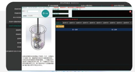
检测项目：水平度、垂直度、同轴度、深度、转速、摆动、温度等参数
